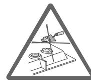
Запрещается непосредственный контакт между средствами с гидравлическим связующими, кроме стандартного строительного раствора, и изнашиваемой поверхностью поддона. Исключить блокировку по вертикали или сбоку.
