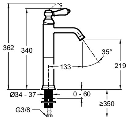
Спецификация продукта: Высокий смеситель для раковины. E24361. Коллекция: LOUISE. РАЗМЕРЫ (СМ): 5.50 x 36.20 см. ВЕС: 1.3 кг. МАТЕРИАЛ: N/A. УСТАНОВКА: 1 отверстие. ТИП: Однорычажный. РАСХОД ВОДЫ: 5 л/мин. ВЫСОТА ПОД ИЗЛИВОМ: 219 мм.
